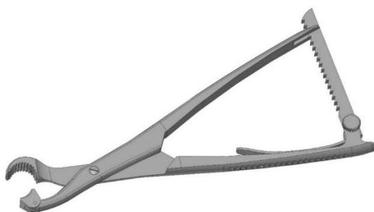
1-сурет. Электрэррозиялық кесу процесін дайындауға арналған 10X17H13M2 болатынан жасалған сүйек ұстағыштың геометриялық моделі
