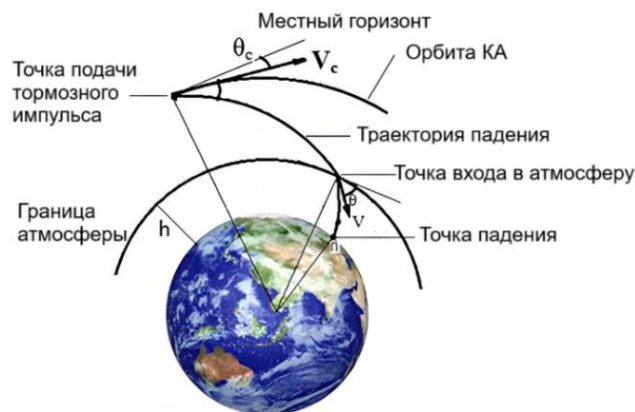
Рисунок 1. Схема траектории входа КА в атмосферу Земли
