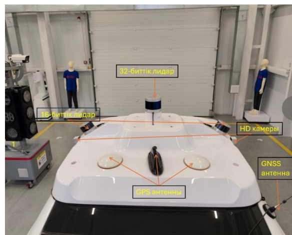
4-сурет. CHANGAN DEEPAL SL03 көлігінде сенсорлық жабдықтар мен спутниктік байланыс құрылғыларының орналасуы
