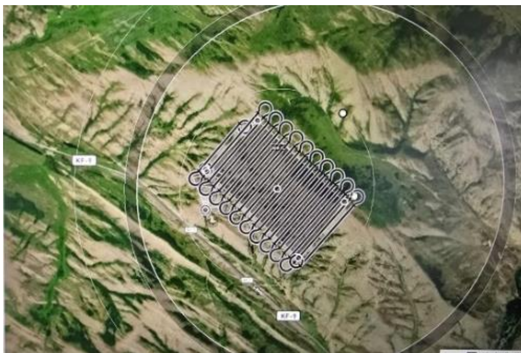
Рисунок 3. План полетной миссии БПЛА senseFly eBee X Примечание – составлено авторами
