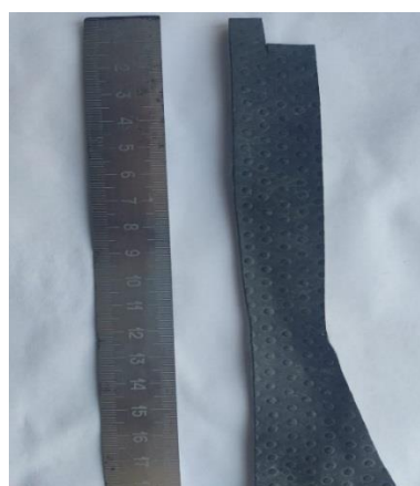
3-сурет. Сыртқы (ТҚП) және ішкі жағынан (геотекстиль) геокомпозит үлгісінің түрі (26-шы блок, 16-шы үйінді, 2022 ж.).
