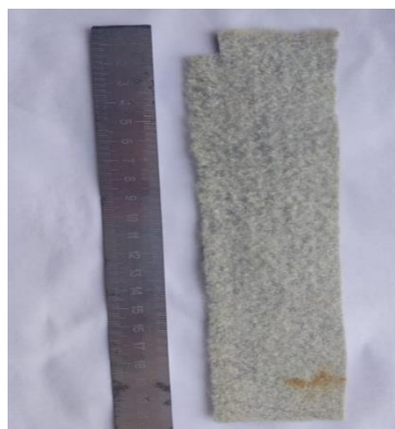
2-сурет. Сыртқы (ТҚП) және ішкі жағынан (геотекстиль) геокомпозит үлгісінің түрі (20-шы блок, 16-шы үйінді, 2021 ж.).
