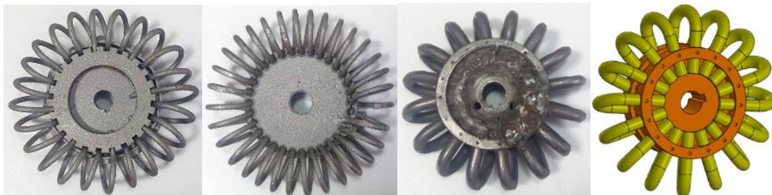
Рисунок 8. Различное исполнение рабочих элементов пружинно-дисковой мельницы Примечание – составлено авторами
