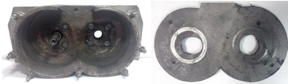
Рисунок 3. Перепускные перегородки с различными проходными отверстиями в них Примечание – составлено авторами
