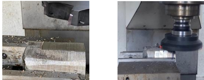
2-сурет. V-Center P76 станогында жоғары жылдамдықты фрезерлеу процесі Ескерту – авторлар құрастырған
