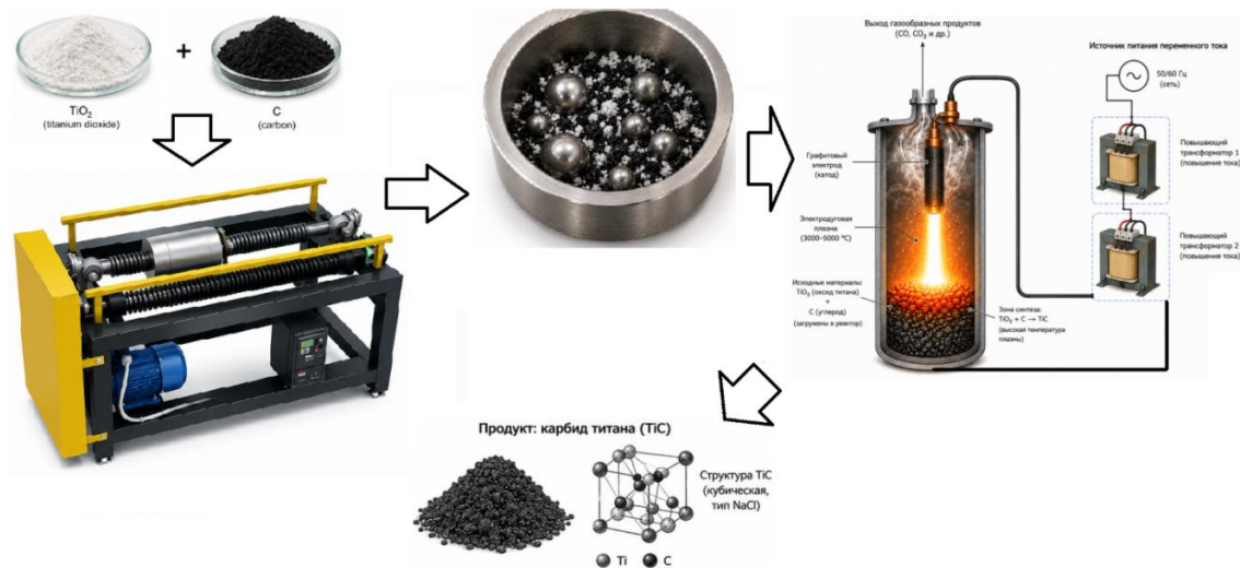
1-сурет. Электрдоғалық әдісті қолдана отырып, титан оксиді мен көміртегінен титан карбидін өндірудің технологиялық схемасы
