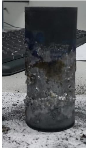
4-сурет. Титан оксиді қалдықтарының ішкі қабырғаға шөгу кезіндегі көрінісі Ескерту – авторлармен эксперимент кезінде жасалған сурет
