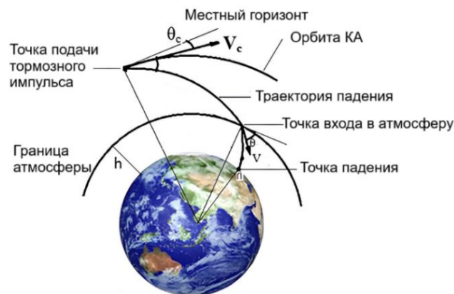
Рисунок 1. Схема траектории входа КА в атмосферу Земли
