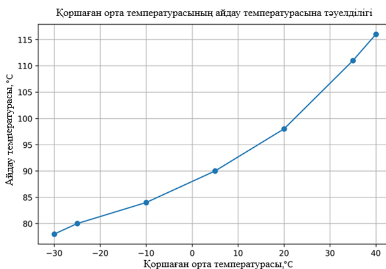
1-сурет. Эксперименттік-есептік модельдеу нәтижелері бойынша бұрандалы компрессордың айдау температурасының қоршаған орта температурасына тәуелділігі Ескерту – Авторлармен құрастырылған
