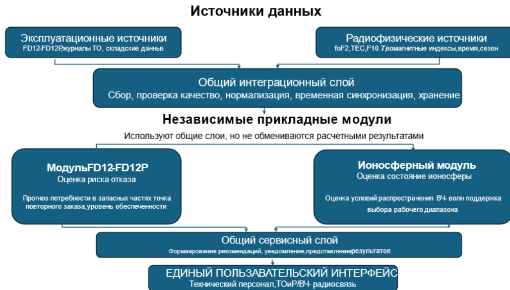
Рисунок 1. Взаимодействие функциональных модулей в архитектуре цифрового двойника авиационной инфраструктуры
