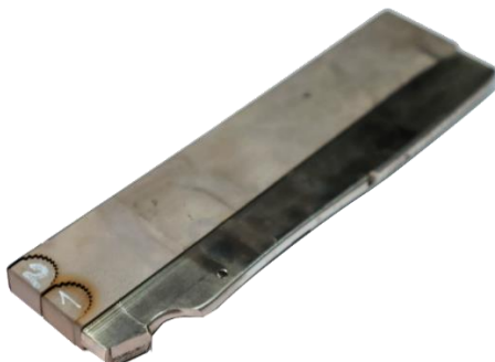
2-сурет. Сымды электр эрозиялық кесуден кейінгі сүйек ұстағыштың жауапты элементтерінің эксперименттік үлгілері
