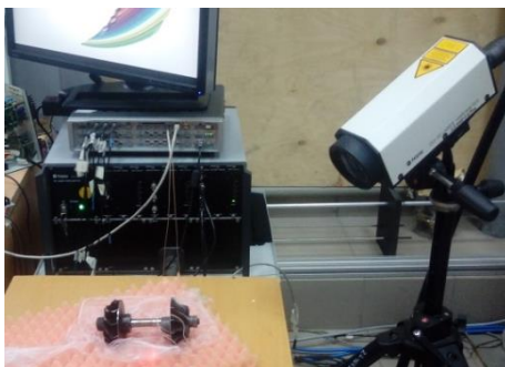
3-сурет. Өлшеу кешені лазерлік виброметр Polytec CLV-3D Laser Vibrometer және зерттелетін жүйесі ротор ТКР
