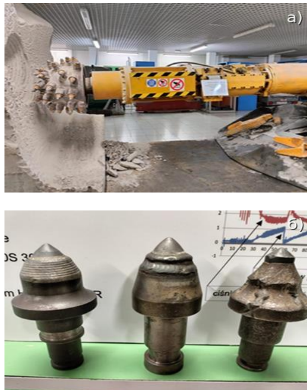
1-сурет. AGH (Польша) Ғылым және технология университетіндегі тау жынысын бұзу процесін модельдейтін ротациялық орындаушы орган:
