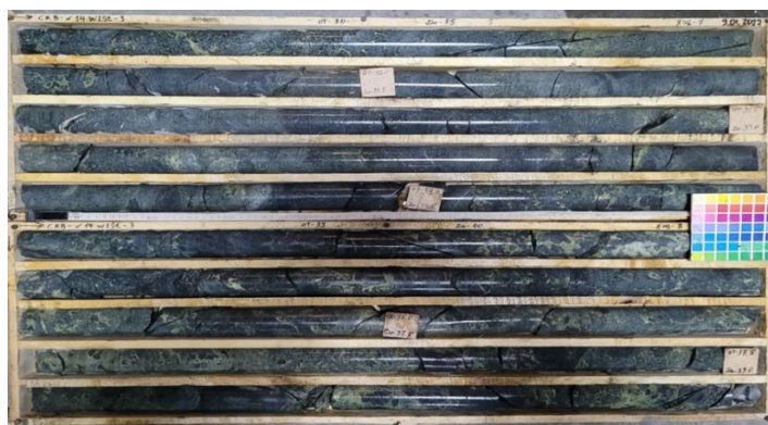
3-сурет. Тұрақты және өте тұрақты жыныстар аймақтарынан алынған керн Ескерту – авторлар құрастырған
