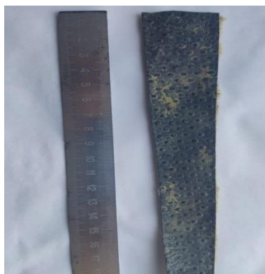
1-сурет. Сыртқы (ТҚП) және ішкі жағынан (геотекстиль) геокомпозит үлгісінің түрі (3-ші блок, 16-шы үйінді, 2020 ж.).
