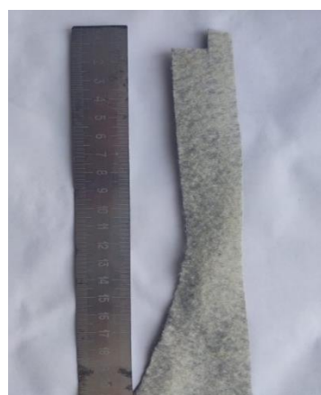
3-сурет. Сыртқы (ТҚП) және ішкі жағынан (геотекстиль) геокомпозит үлгісінің түрі (26-шы блок, 16-шы үйінді, 2022 ж.).
