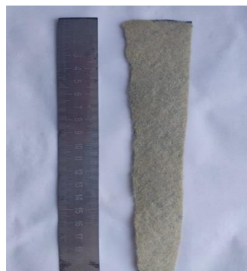
1-сурет. Сыртқы (ТҚП) және ішкі жағынан (геотекстиль) геокомпозит үлгісінің түрі (3-ші блок, 16-шы үйінді, 2020 ж.).
