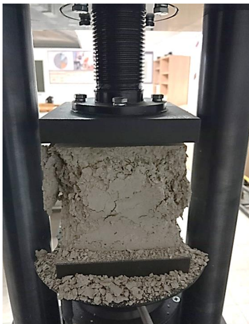
Рисунок 5. Пресс ПГМ-МГ4 для определения прочности лабораторных бетонных образцов
