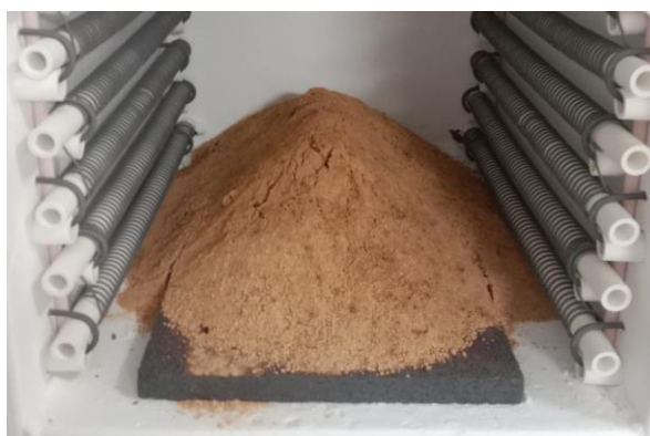
Рисунок 2. Обжиг диатомита в электропечи ЭКПС 50/1300
