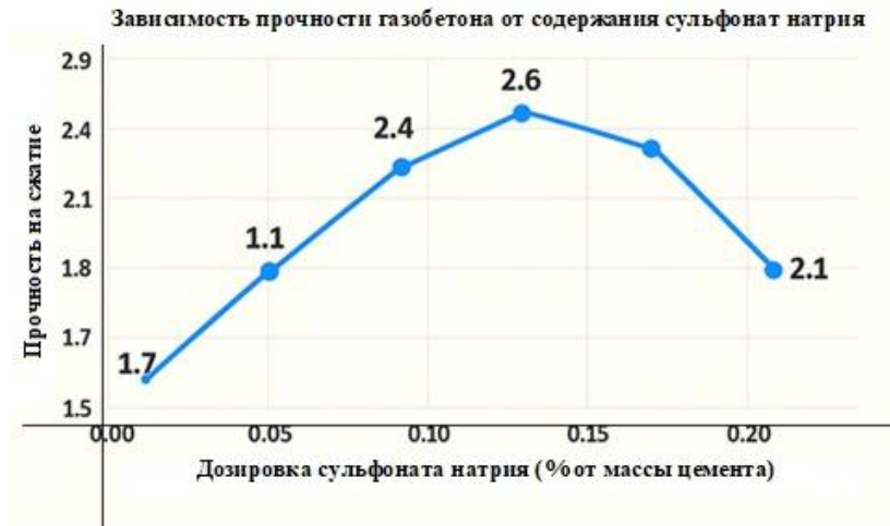
Рисунок 1. График зависимости прочности газобетона от содержания сульфата натрия
