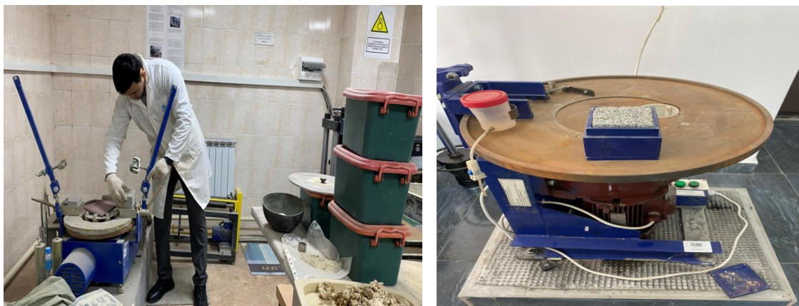
Рисунок 6. Испытания образцов газобетона на величину истираемости
