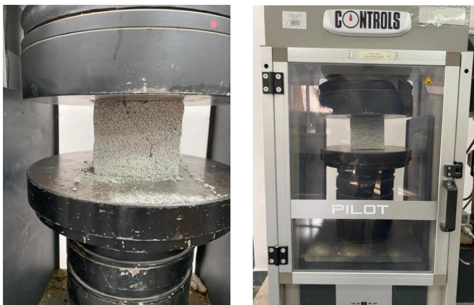
Рисунок 4. Испытаний образцов газобетона на прочность при сжатии
