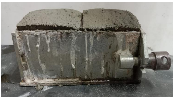
Рисунок 3. Формование газобетона в форме куба 2 ФК – 100
