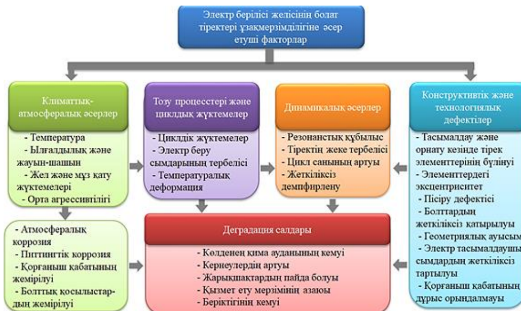
1-сурет. Электр желілерінің болат тіректерінің ұзақмерзімділігіне әсер ететін факторлардың диаграммасы
