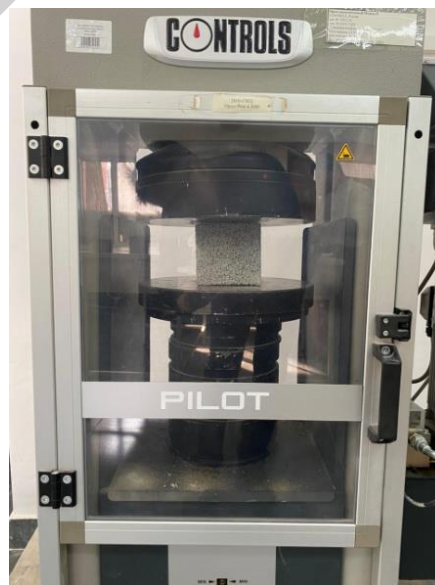
Рисунок 4. Испытаний образцов газобетона на прочность при сжатии
