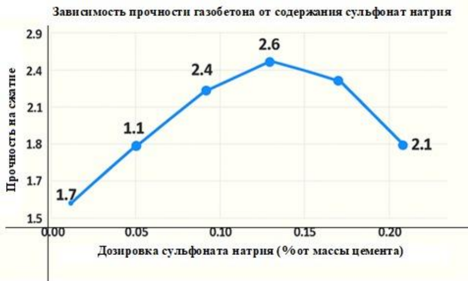
Рисунок 1. График зависимости прочности газобетона от содержания сульфат натрия
