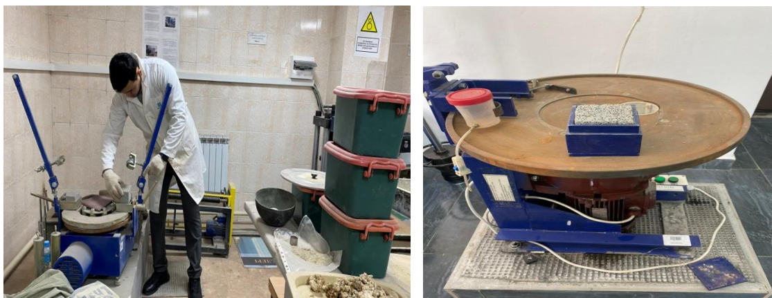
Рисунок 6. Испытания образцов газобетона на величину истираемости
