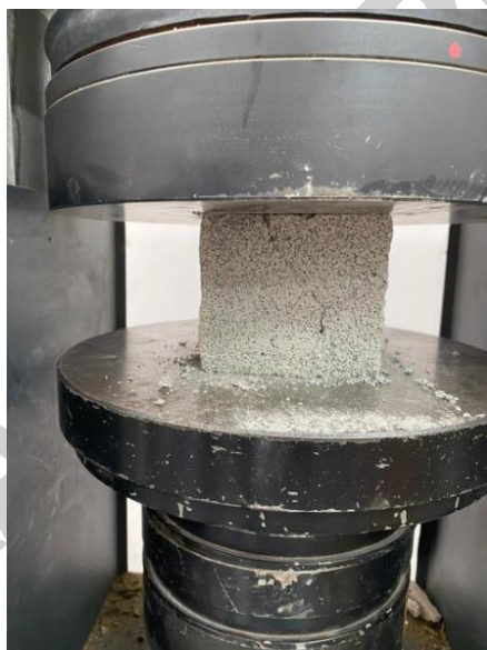
Рисунок 4. Испытаний образцов газобетона на прочность при сжатии
