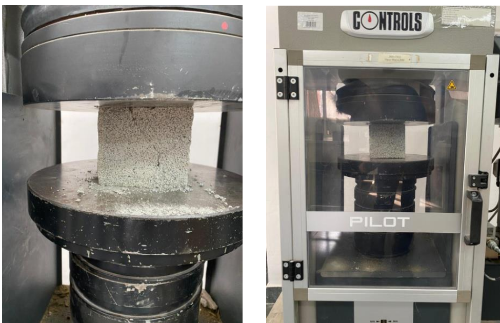
Рисунок 4. Испытаний образцов газобетона на прочность при сжатии
